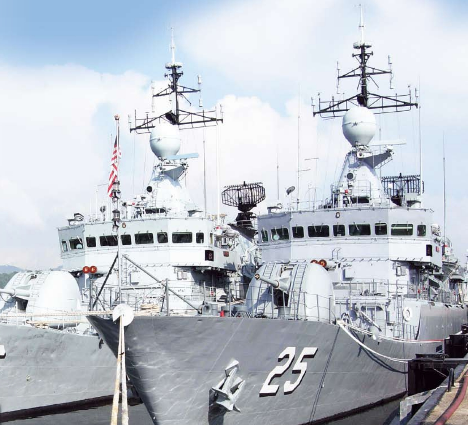
De Maleisische korvetten KD Kasturi en KD Lekir. Deze 25 jaar oude korvetten worden omgebouwd om de levensduur met 15 jaar te verlengen. Nevesbu is Platform System Integrator in het project.
